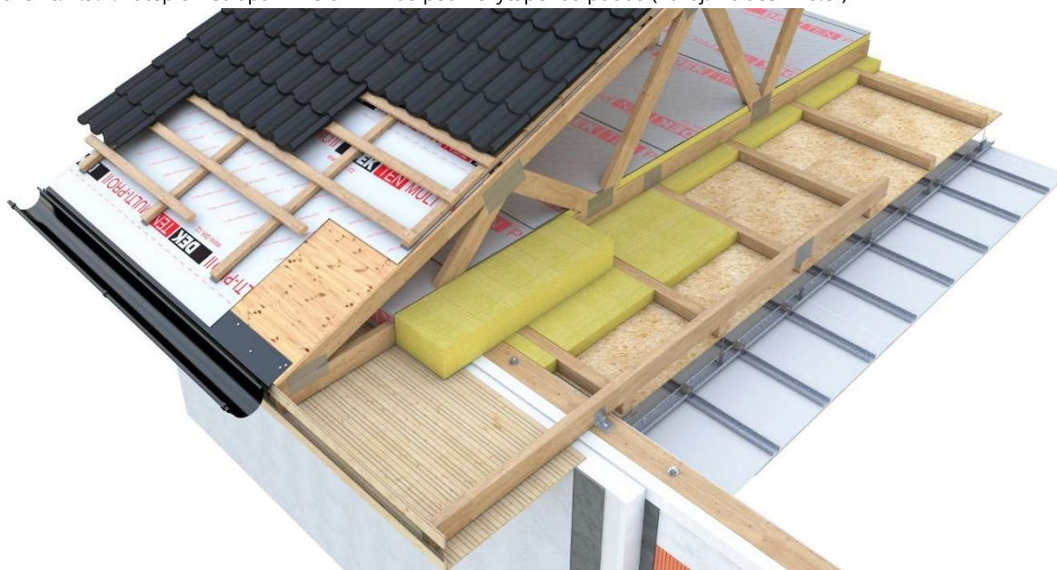
Obrázek č. 4.9.2: Zateplení stropu minerální vlnou pod nevytápěnou půdou (Zdroj: izolace-info.cz)
